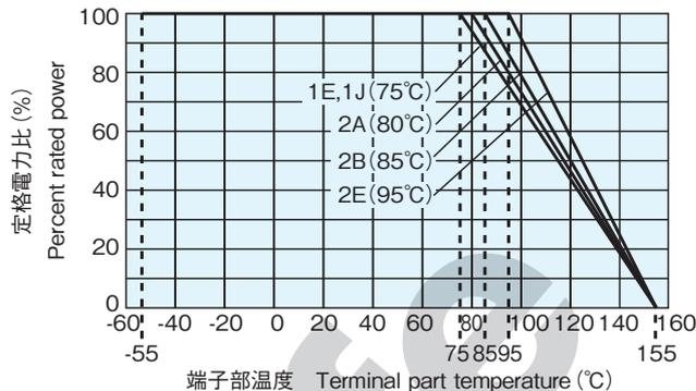
周囲温度70℃以上で使用される場合は、上図負荷軽減曲線に従って、定格電力を軽減して御使用ください。
