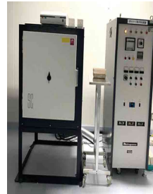
更新後恒温槽
