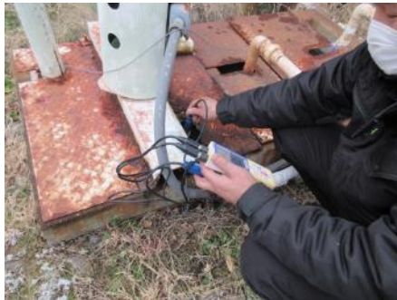
ポータブルpH計を使用し、社内でもpH値を測定して監視する様子
